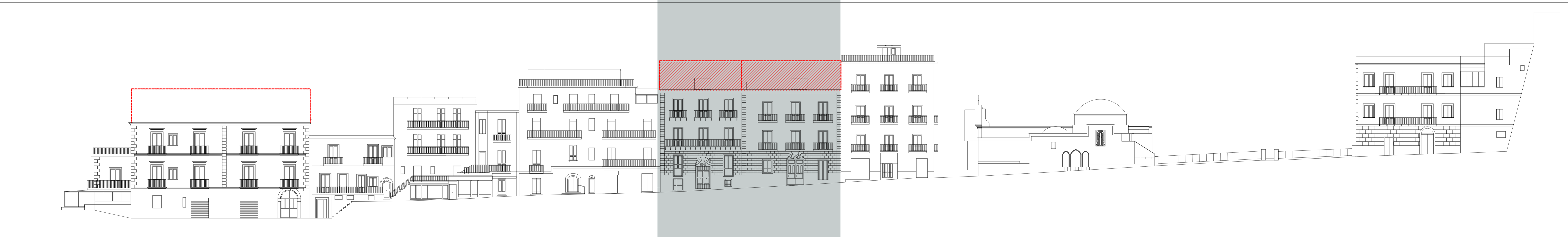
INVILUPPO DEI VOLUMI DEMOLITI E DA RICOMPORRE Via G. Matteotti - Profilo Sud
